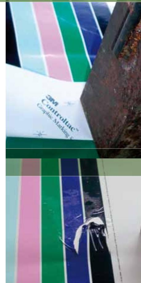
ungenügende Trocknung – Lösemittel-Tinten
