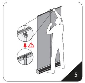
5. Bitte beachten Sie das der obere Klemmleiste gut auf dem Halter befestigt wird. Diese soll flach an dem Halter befestigt werden.
