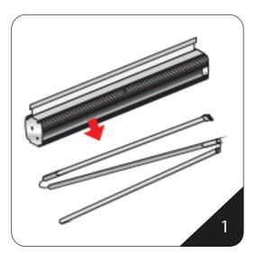
1. Nehmen Sie den Pole aus der Hinterseite der Kassette.
