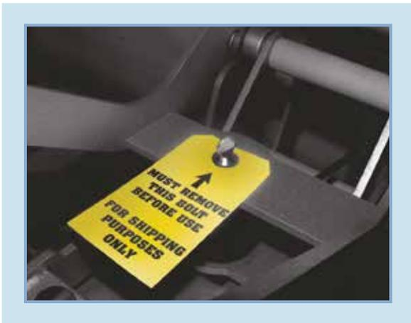
Zur Inbetriebnahme Ihrer Presse müssen Sie die Transportsicherung entfernen, indem Sie die Schraube entfernen. Erst nach dem Entfernen der Transportsicherung ist Ihre Maschine einsatzbereit.
